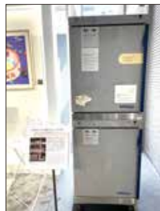
世界初の iPS 細胞を生んだ培養器： 湿度・温度・二酸化炭素濃度を培養に適したものに保つことができる
