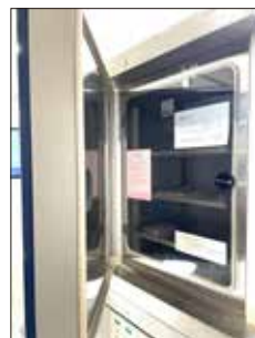
世界初の iPS 細胞を生んだ培養器： 湿度・温度・二酸化炭素濃度を培養に適したものに保つことができる
